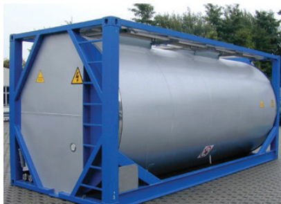
Un tanque dedicado, (iso tanque) se muestra con el recubrimiento de protección en su interior.
